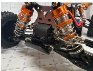
Ammortizzatori ad olio in metallo con molle regolabili ant/post.
